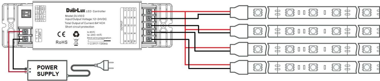
Application Circuit 2: CW+WW( V+→COMMON、CH1→CW、CH2→WW、CH3→CW, CH4: WW.)
